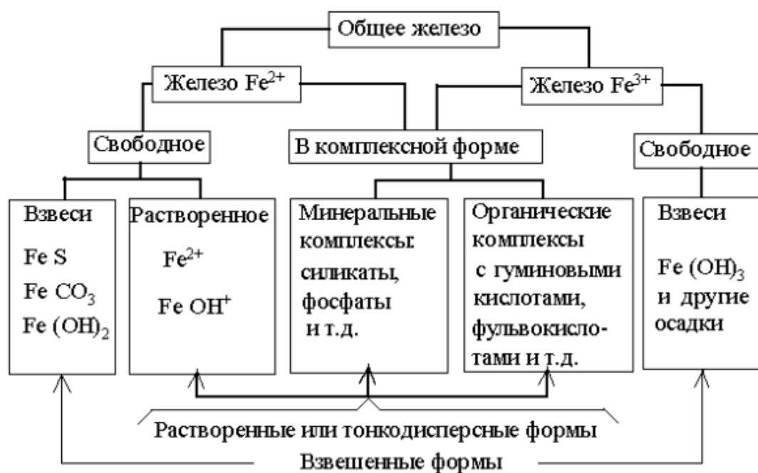
Рис. 1. Схемы существования различных форм железа в воде
